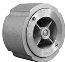
CV 91-SS Clase 150/300 Tipo Wafer - Silenciosa Acero Inoxidable Tamaños: 2 ~ 12"
