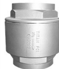
CV 80-SS Clase 300 Roscados / En Línea Acero Inoxidable Tamaños: \frac{3}{8} ~ 3"
